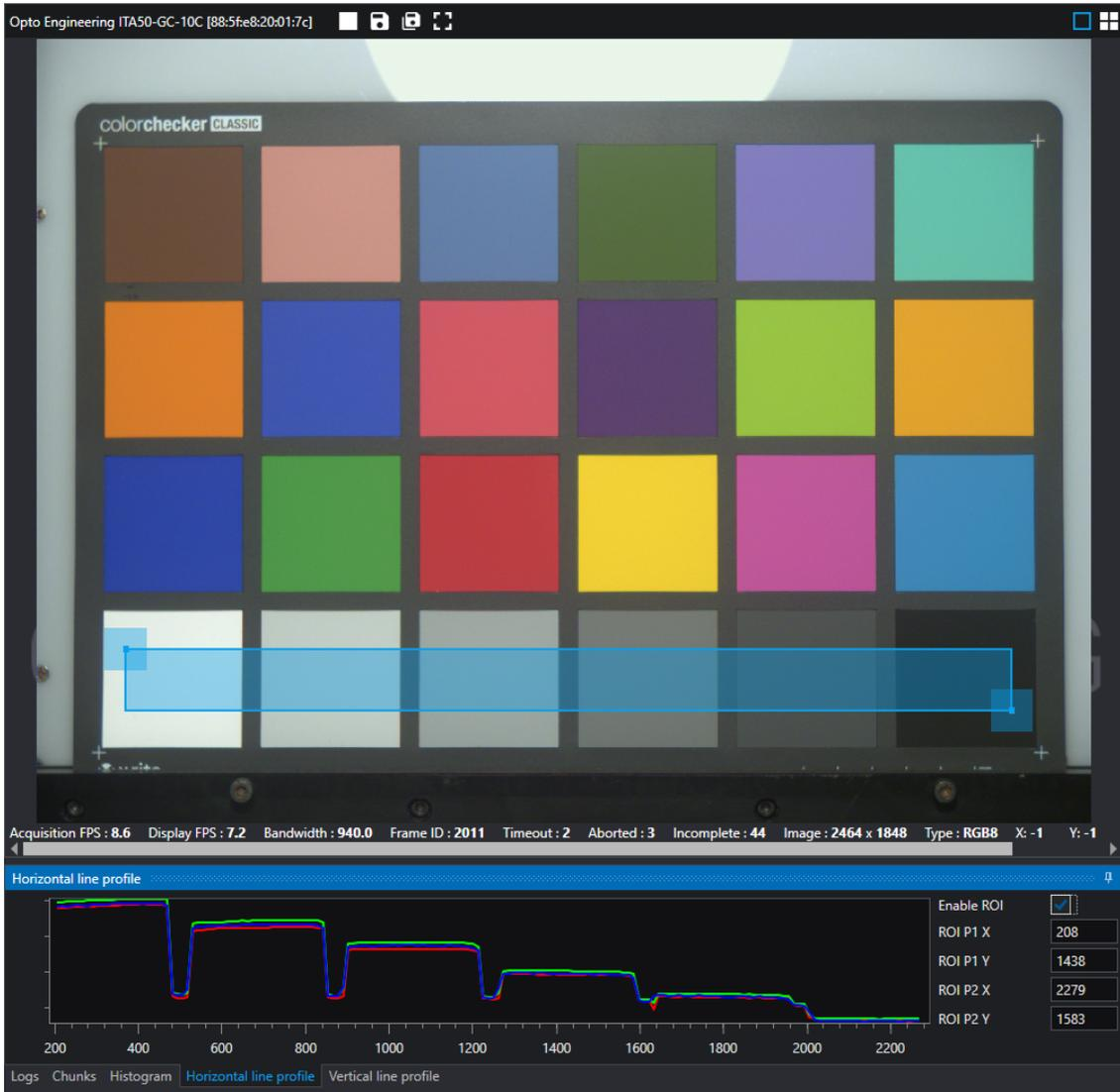
Figure 73: 颜色校准程序后的颜色检查器。
