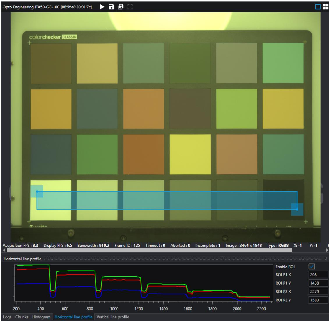
Figure 70: 色彩校准程序的第二步: *Exposure Time* 和 *Gamma* 调整, 使绿色通道与色彩校验器施加的值相匹配。
