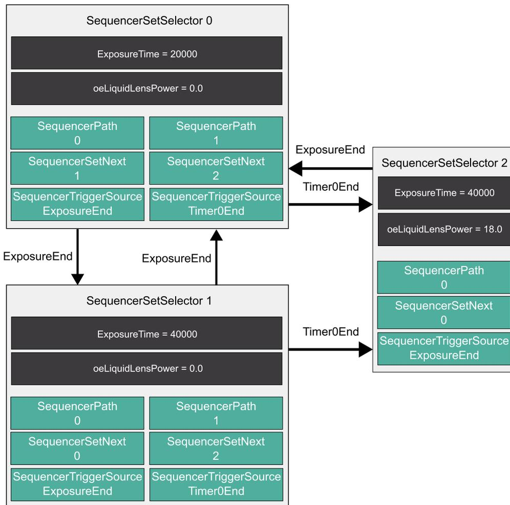
Figure 100: 定序器控制路径示例流程图。
