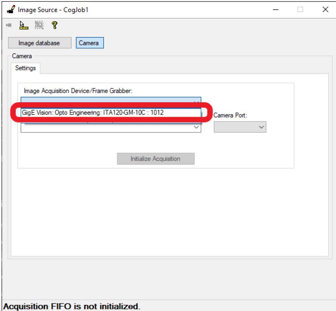
Figure 95: 第 8 步 - *Image Source* 窗口，*Image Acquisition Device* 选项。
