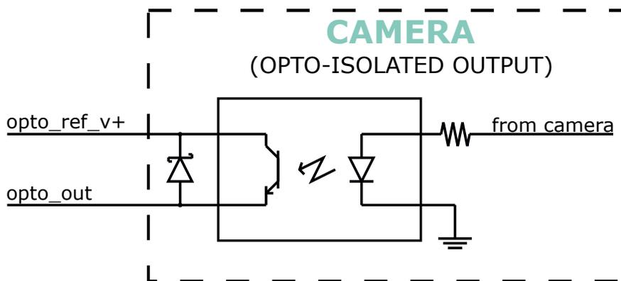
Figure 42: 光电隔离输出拓扑结构。
