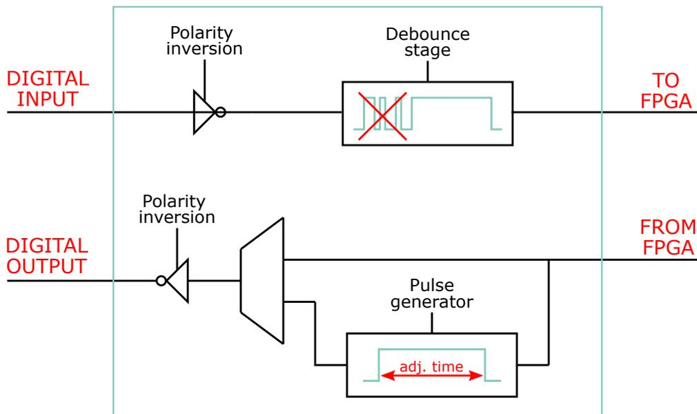
Figure 74: 数字输入/输出级表示法
