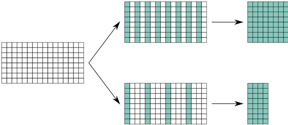
Figure 46: 细分示例：上图进行了 2x1 细分，下图进行了 4x1 细分。
