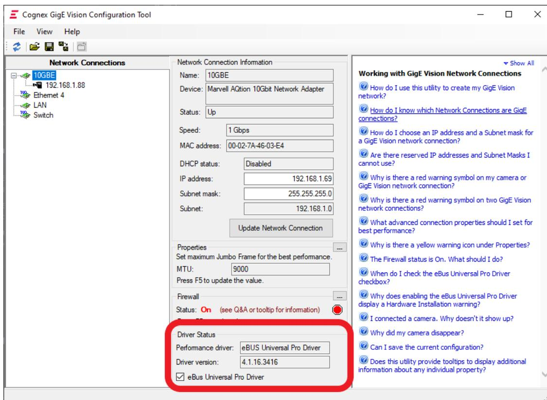
Figure 92: 第 4 步 - *Cognex GigE Vision Configuration Tool* 窗口。
