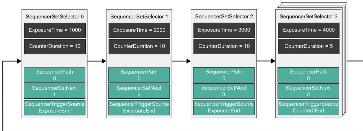
Figure 99: 定序器控制示例流程图
