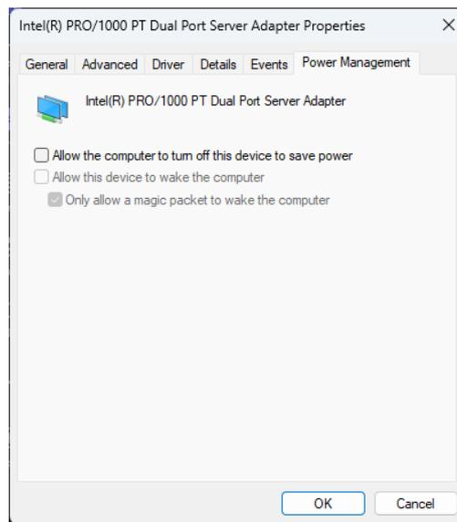
Figure 8: 网卡电源管理设置：应禁用设备关闭。
