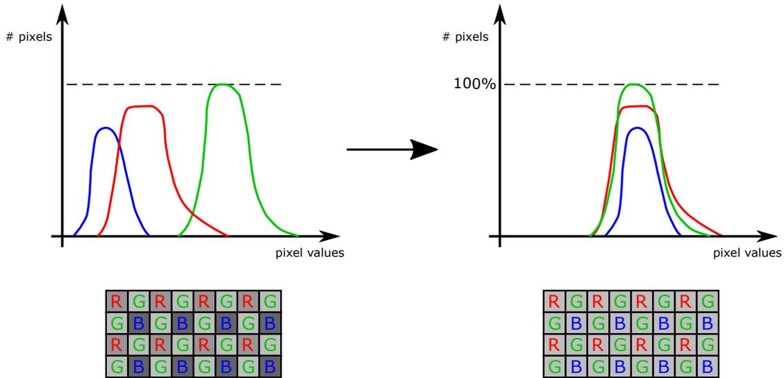
Figure 58: 左边是彩色传感器典型光谱灵敏度的直方图。右图是白平衡相机的直方图。
