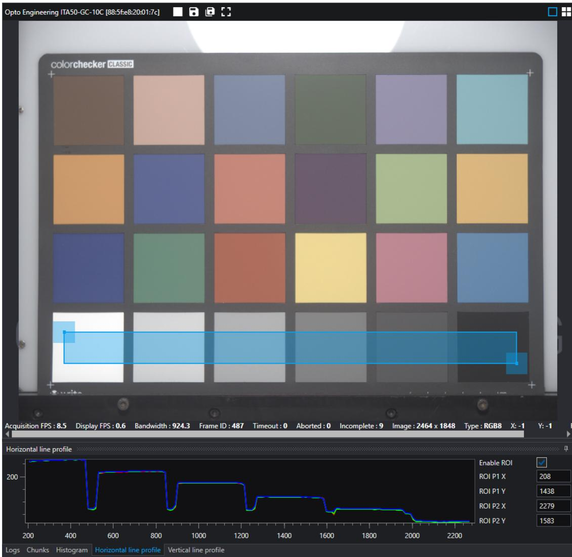
Figure 71: 色彩校准步骤的第三步：使用 *BalanceRatio* 功能，调整红色和蓝色通道，以便在水平线轮廓选项卡中叠加所有三条色彩曲线。
