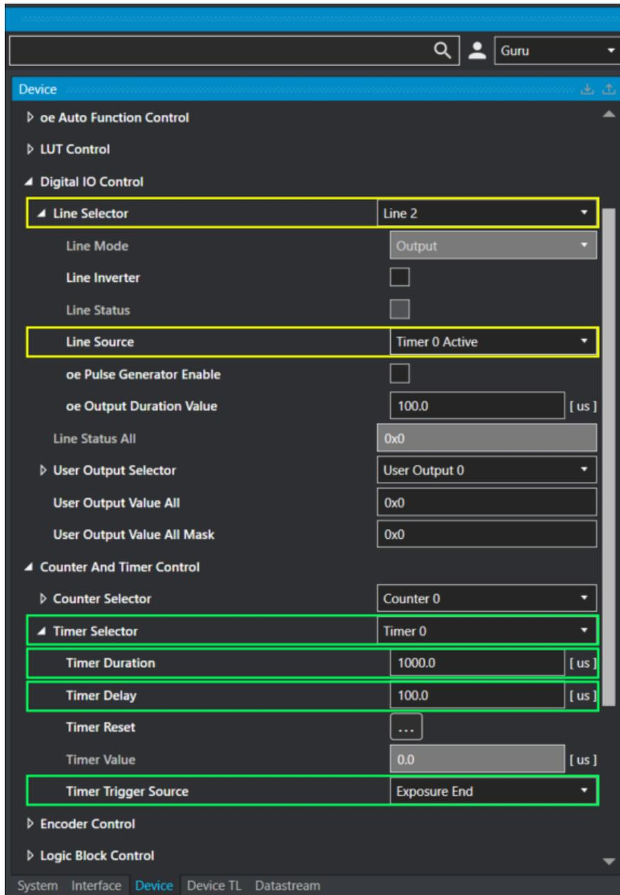
Figure 87: 使用 Itala View 实现输出延迟脉冲
