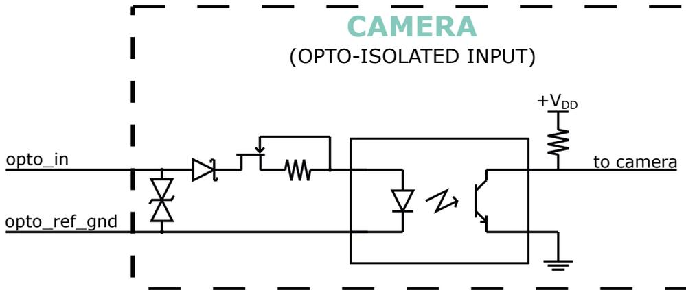
Figure 41: 光电隔离输入拓扑结构。
