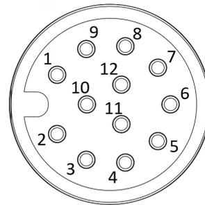
Figure 40: IP67 12 针圆形连接器引脚（摄像机正面图）。
