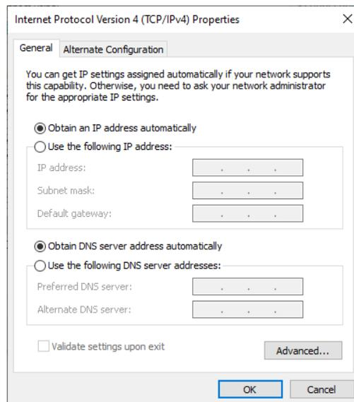
Figure 6: 网络连接的 DHCP 配置。
