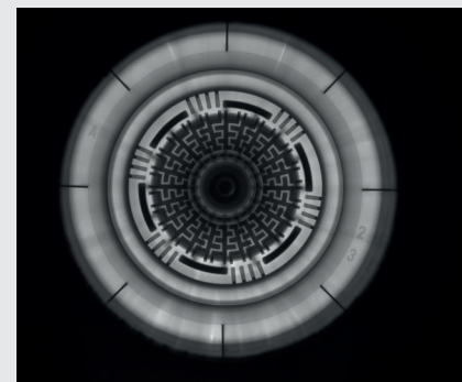
OCR e ispezione su capsula di caffè OCR and visual inspection on a coffee capsule
