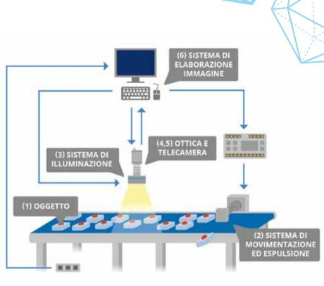
geometria e lunghezza d'onda prodotta sono scelte in modo tale che le caratteristiche da ispezionare siano rilevate facilmente e in modo affidabile e l'effetto della luce ambientale sia ridotto al minimo. L'immagine dell'oggetto stesso viene quindi acquisita attraverso l'ottica (4) e impressa sul sensore della telecamera (5). L'immagine viene infine elaborata per estrarre le informazioni richieste (6).
